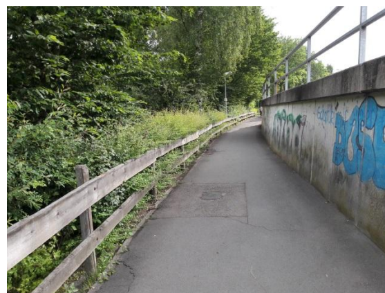
Böschung zur Nemphe; wird abgeflacht und ausgelichtet
